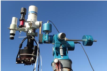
図 1 口径 6cm CCD 測光望遠鏡
