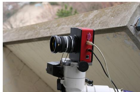
光学系はカメラレンズを用いて視野の広さを確保した。フィルターは 5cm 角のものをレンズの前に付けている。撮影には、ACP Observatory Control Software を用い、M 天体や NGC 天体を中心座標に指定して、さそり座、へびつかい座、いて座、わし座付近の 9 視野を連続で撮影を行っている。露出は 60 秒で、1 星野あたり 5 枚ずつ撮影をしている。撮影場所は、自宅のベランダであるが、Ic バンドを用いることで、光害もある程度避けることが出来、市街地での撮影が可能となっている。極限等級は、10-11 等程度で、目的のためにはもう少し暗いほうが良いが、当面、現状のセッティングで撮影を行うこととした。当初、より波長の長い SDSS z バンドでの撮影も試みたが、CCD カメラ感度との兼ね合いから、極限等級が思ったより良くな、断念した。2010 年 3 月-6 月上旬に、19 夜ほど撮影が行えたが、月の影響など
